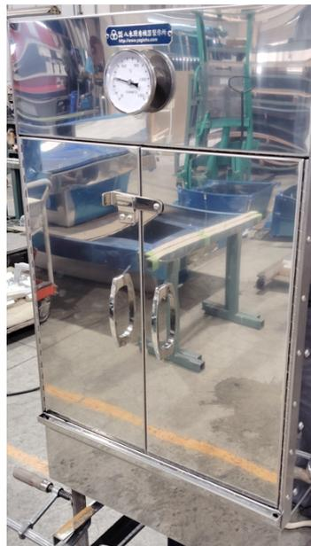
蒸した後にそのまま放水シャワーで食品を冷却可能な、一体型蒸し器を開発した
